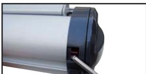
**Scaricamento molla** • Per scaricare la molla e sostituire la stampa utilizzare una punta metallica (es. Cacciavite) premento l'ingranaggio rosso, attenzione non utilizzare assolutamente le dita potreste causarvi delle ustioni dovute alla forte velocità di scaricamento della molla.
